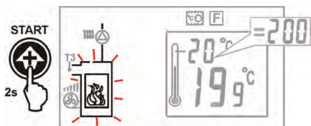
Fig.3. Creșterea temporară de putere în modul EMISIE PID
